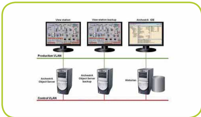
Рис. 2. Архитектура системы на обогатительной фабрике
