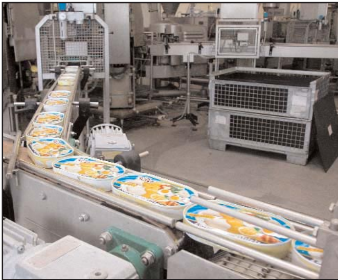
Банки с рыбой подаются по конвейеру к месту конечной упаковки
